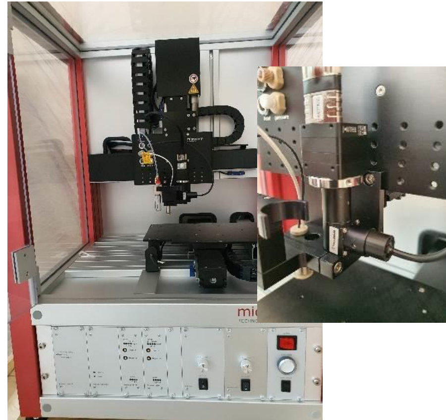
ПРИНТЕР ЗА ОТЛАГАНЕ НА ТЪНКИ СЛОЕВЕ ОТ МАТЕРИАЛИ (INKJET 3D PRINTER FOR MATERIALS AND MEMS FABRICATIONS PROCESSES)
