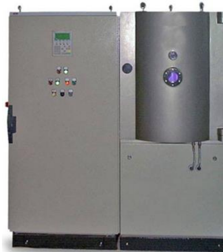
ПРОЦЕСНА КАМЕРА ЗА ИЗГРАЖДАНЕ НА ПОКРИТИЯ
