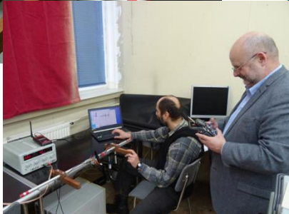
ЕКСПЕРИМЕНТАЛНА УСТАНОВКА ЗА ИЗМЕРВАНЕ НА СИЛИТЕ И МОМЕНТИТЕ НА ВЪЗДУШНИ ВИТЛА НА МАЛКИ БЕЗПИЛОТНИ ЛЕТАТЕЛНИ АПАРАТИ
