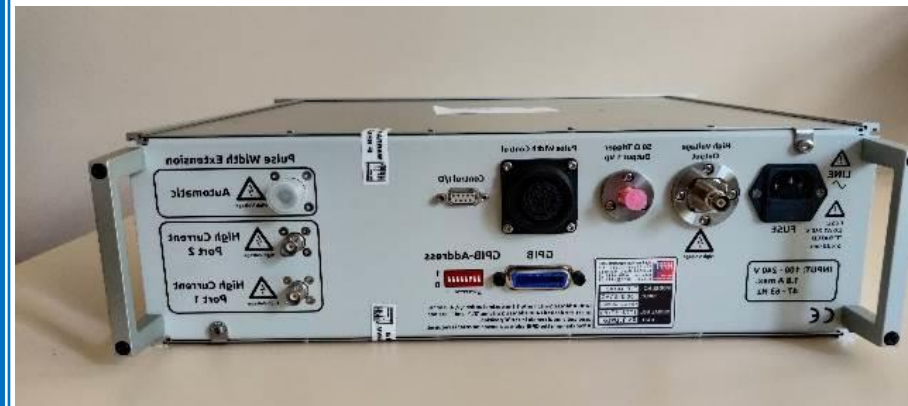
ТЕСТЕР ЗА ПУЛСИРАНЕ НА ПРЕДАВАТЕЛНИ ЛИНИИ (TLP - TRANSMISSION LINE PULSE TESTER)
